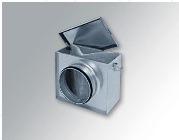
Фильтры ФЛК предназначены для очистки воздуха от пыли в системах вентиляции и кондиционирования воздуха. Корпус и крышка фильтров изготовлены из оцинкованной стали. Крышка крепится к корпусу защёлкой. Корпус фильтра снабжён круглыми патрубками с резиновым уплотнением для подсоединения к воздуховодам или другим элементам вентиляционной системы. Фильтрующий материал выполнен в виде панели из синтетического волокна и имеет класс очистки G3
