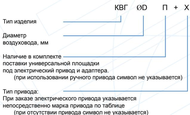
**Пример обозначения при заказе клапана воздушного герметичного для круглого воздушного канала диаметром 315 мм с установленным электроприводом «PolarBear» AST16.S с двумя встроенными вспомогательными переключателями. Напряжение питания электропривода 230 В:**
