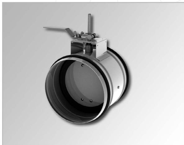
Клапан воздушный герметичный (КВГ) предназначен для установки в воздуховодах систем приточной и вытяжной вентиляции в качестве запорного устройства с целью надёжного отключения воздухообмена помещений от наружной среды или одних помещений от других.
