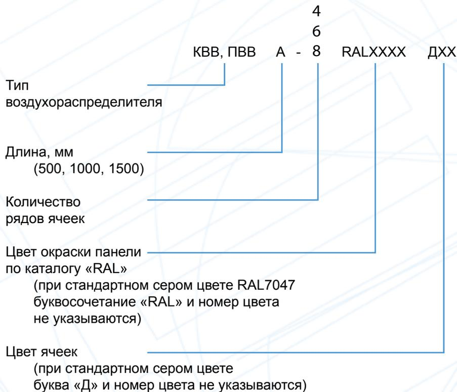
Пример обозначения при заказе воздухораспределителя с линейными ячейками для круглого воздуховода КBB, с условной длиной 1000 мм, с шестью рядами ячеек, панель окрашена в чёрный цвет RAL 9005, пластиковые ячейки тоже чёрного цвета:
