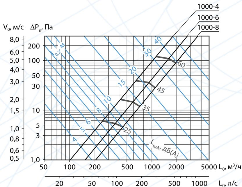
**Аэродинамические и акустические характеристики воздухораспределителей КВВ длиной 1000 мм при подаче воздуха в помещение по схеме 3 потоком, направленным в одну сторону в плоскости панели**
