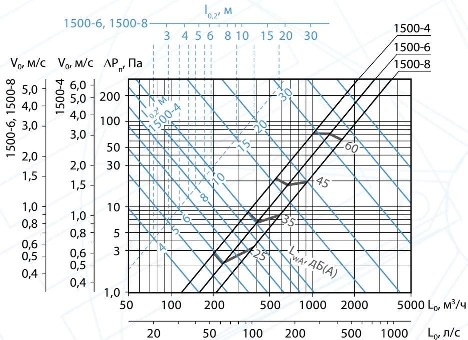
**Аэродинамические и акустические характеристики воздухораспределителей КВВ длиной 1500 мм при подаче воздуха в помещение по схеме 1 прямооточным потоком перпендикулярно панели**
