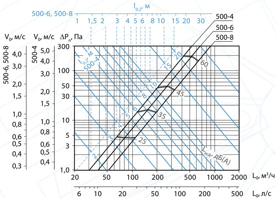
**Аэродинамические и акустические характеристики воздухораспределителей ПВВ длиной 500 мм при подаче воздуха в помещение по схеме 1 прямоточным потоком перпендикулярно панели**
