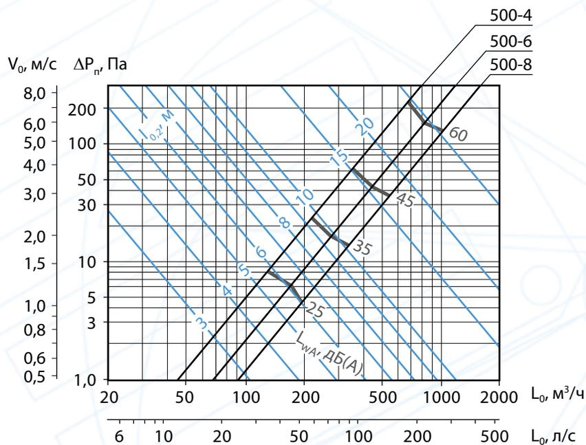
**Аэродинамические и акустические характеристики воздухораспределителей КВВ длиной 500 мм при подаче воздуха в помещение по схеме 3 потоком, направленным в одну сторону в плоскости панели**
