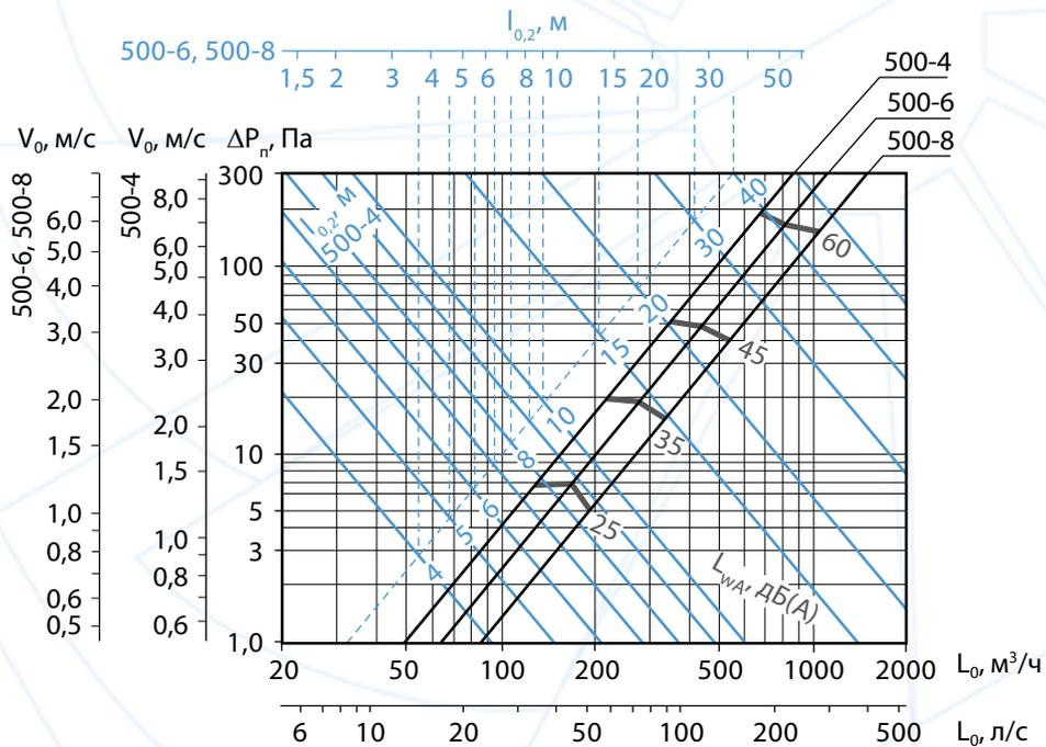
**Аэродинамические и акустические характеристики воздухораспределителей ПВВ длиной 500 мм при подаче воздуха в помещение по схеме 2 дальноточным потоком перпендикулярно панели**
