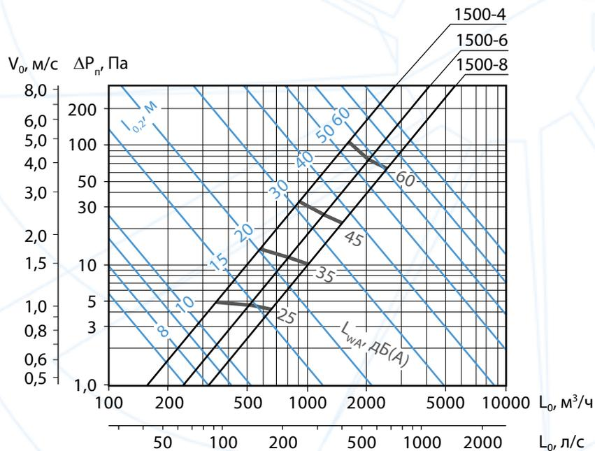
**Аэродинамические и акустические характеристики воздухораспределителей КВВ длиной 1500 мм при подаче воздуха в помещение по схеме 2 дальнобойным потоком перпендикулярно панели**
