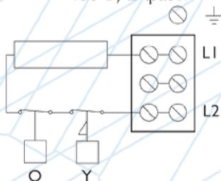
Q - термостат защиты от перегрева, температура срабатывания 55°C;
