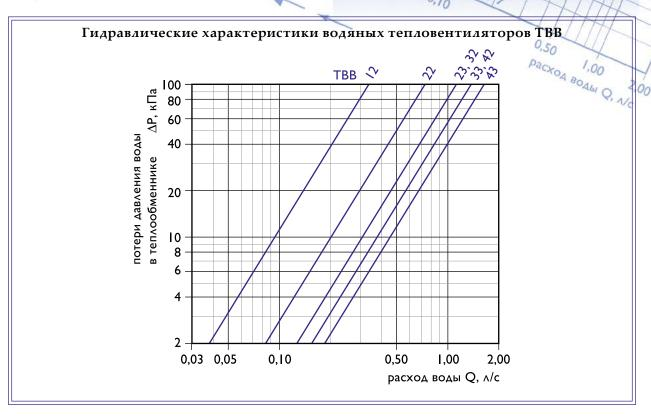
Потери давления в теплообменнике приведены для средней температуры горячей воды  $0.5(t_{_{\rm BX}}+t_{_{\rm BMX}})=70~{}^{\circ}{\rm C.}$  Для других значений величину потерь давления необходимо умножить на коэффициент К.
