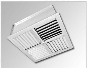
Панельные воздухораспределители вихревые ВПЛ предназначены для подачи воздуха системами вентиляции и кондиционирования в изотермическом и неизотермическом режиме в помещения различного назначения (общественные, административные, производственные) высотой от 2,7 метров и более.
