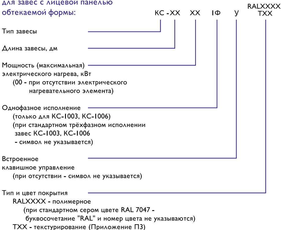
Пример заказа завесы «Классик» длиной 1500 мм с встроенным управлением, с мощностью нагрева до 9 кВт, серого цвета RAL7047:
