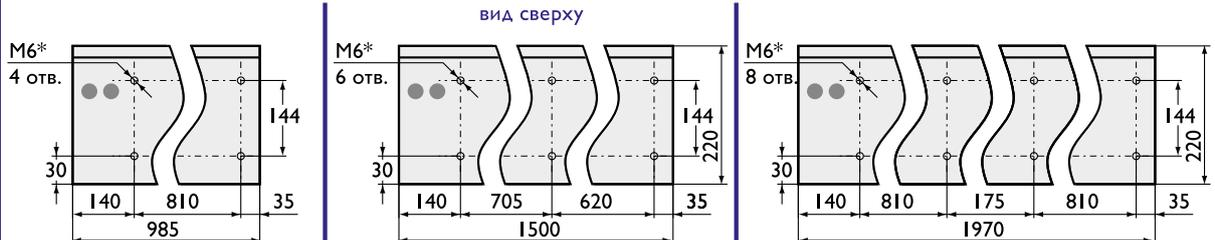
\* - отверстия для горизонтального монтажа
