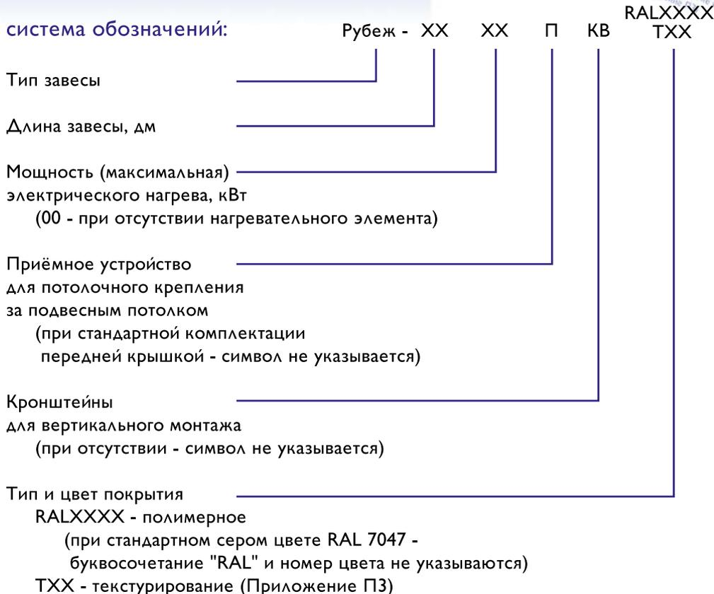
Пример заказа завесы «Рубеж» длиной 1500 мм (фактическая длина 1496 мм), с мощностью нагрева до 12 кВт, серого цвета RAL7047, с кронштейнами для вертикального монтажа:
